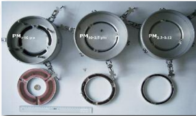
Chemvol-Sampler zur Messung von Allergenen in drei Grössenfraktionen von Schwebstaubpartikeln
